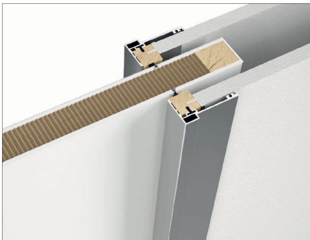
Porta scorrevole a scomparsa con stipite piatto / Pocket sliding door with flat jamb
